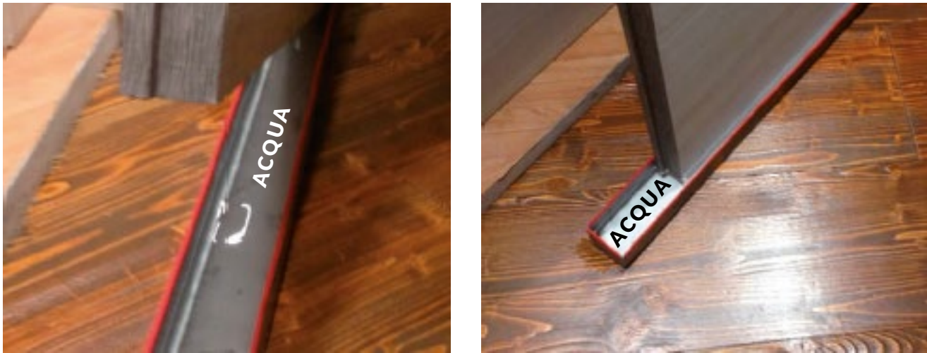
Test con anta immersa in acqua
