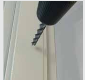
placca antiperforazione abbinata a maniglia con chiave, requisito per RC 2
